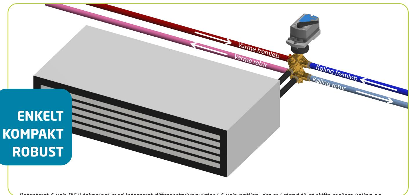
*Patenteret 6-vejs PICV-teknologi med integreret differenstrykregulator i 6-vejsventilen, der er i stand til at skifte mellem køling og varme uden behov for en ekstra ventil til trykuafhængig modulation*
