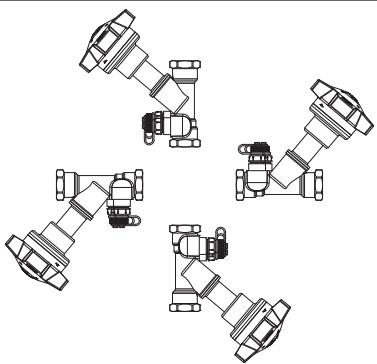
(DK) **FIG 2:** Ventilen kan positioneres frit i rørsystemet.
